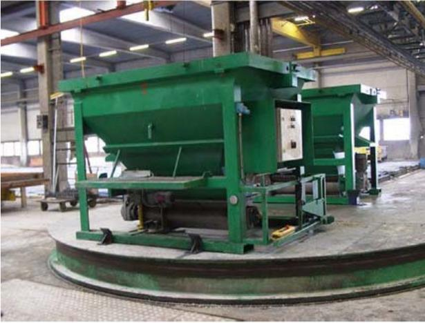
**Figura 12.1** Uso de un tanque amasador intermedio para activar el HAC justo antes de la aplicación.
