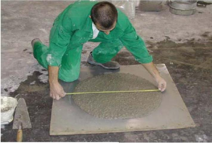
Figura 9.1. Ensayo de escurrimiento
