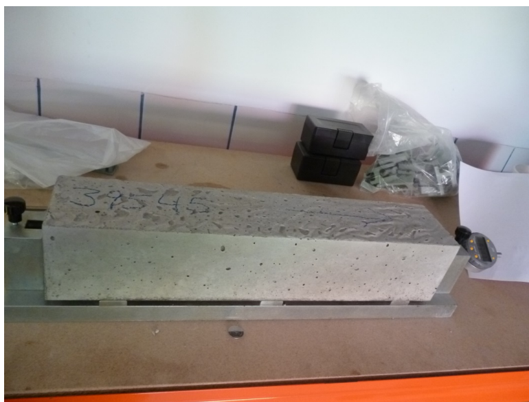
Imagen de probeta de retracción colocada en un comparador para su medida
